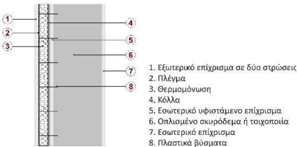
Εικόνα 1: Ενδεικτική τομή εξωτερικής θερμομόνωσης
